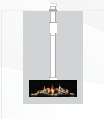
Système d'évacuation forcée en ligne avec conduit vertical
